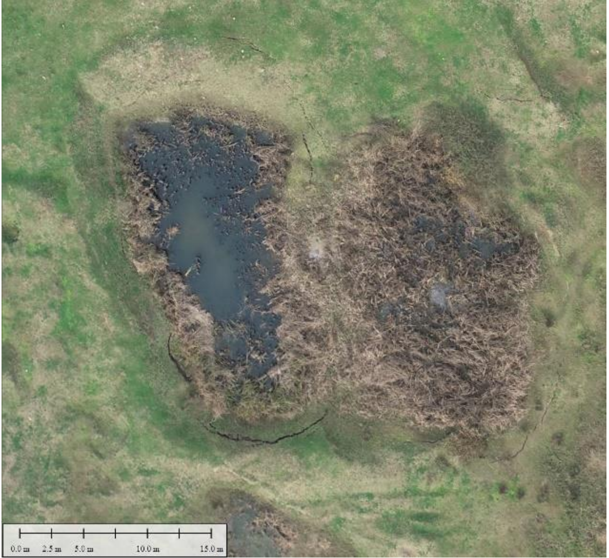
Şekil 13. Düzce depremi sırasında/hemen sonrasında gelişen zemin sıvılaşması ve yanıl yayılmaya ait drone görüntüsü. Otlar arasındaki gri renkli kesimler sıvılaşma sırasında yüzeye gelmiş kum boyutundaki malzemeyi göstermektedir.
